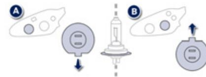
Pour le remontage, effectuez ces opérations dans le sens inverse, en orientant l'ergot de positionnement de la lampe vers le bas (modèle **A**) ou vers le haut (modèle **B**).
