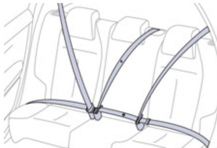
Les places arrière sont équipées chacune d'une ceinture, dotée de trois points d'ancrage, et, pour les places latérales, d'un limiteur d'effort.
