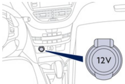
☞ Pour brancher un accessoire 12 V (puissance maxi : 120 Watts), relevez le couvercle et branchez l'adaptateur adéquat.
