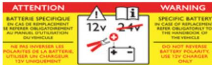
La présence de cette étiquette, notamment avec le Stop & Start, indique l'utilisation d'une batterie au plomb 12 V de technologie et de caractéristiques spécifiques, qui nécessite, en cas de remplacement ou de débranchement, une intervention du réseau PEUGEOT ou d'un atelier qualifié.
