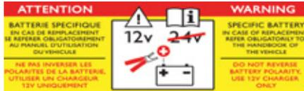
La présence de cette étiquette indique l'utilisation d'une batterie au plomb 12 V de technologie et de caractéristiques spécifiques, qui nécessite, en cas de débranchement ou de remplacement, une intervention du réseau PEUGEOT ou d'un atelier qualifié.
