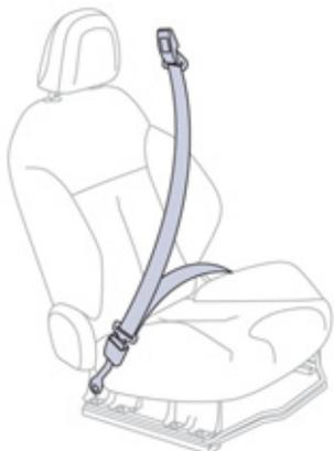
Les ceintures de sécurité avant sont équipées d'un système de prétension pyrotechnique et de limiteur d'effort.
