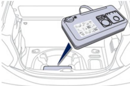
Ce kit est installé dans le caisson de rangement, sous le plancher de coffre.
