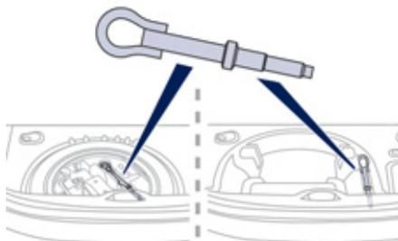
L'anneau de remorquage est installé dans le coffre sous le plancher.
