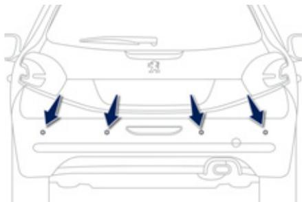
A l'aide de capteurs situés dans le pare-chocs, cette fonction vous signale la proximité de tout obstacle (personne, véhicule, arbre, barrière...) qui entre dans leur champ de détection. Certains types d'obstacle (piquet, balise de chantier...) détectés au début ne le seront plus en fin de manoeuvre en raison de la présence de zones aveugles.
