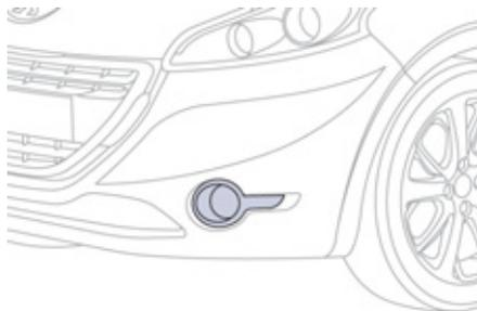
En feux de croisement ou en feux de route, cette fonction permet au faisceau du projecteur antibrouillard avant d'éclairer l'intérieur du virage, lorsque la vitesse du véhicule est inférieure à 40 km/h (conduite urbaine, route sinueuse, intersections, manoeuvres de parking...).
