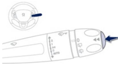
☞ Appuyez sur le bouton, situé à l'extrémité de la **commande d'essuie-vitre**, pour afficher successivement les différents onglets.
