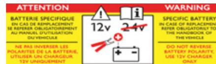
**|** Le Stop & Start fait appel à une technologie avancée. Toute intervention sur ce type de batterie doit être réalisée exclusivement dans le réseau PEUGEOT ou dans un atelier qualifié.
