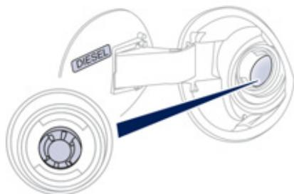
**i** L'utilisation d'un jerrican reste possible pour remplir lentement le réservoir. Afin d'assurer un bon écoulement du carburant, approchez l'embout du jerrican sans le plaquer directement contre le volet du détrompeur.
