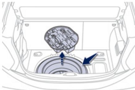
La roue de secours est installée dans le coffre sous le plancher. Suivant la destination, la roue de secours est en tôle, en aluminium ou de type «galette». Pour y accéder, voir le paragraphe «Accès aux outillages» de la page précédente.
