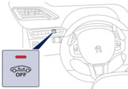
Système de protection et de dissuasion contre le vol et l'effraction. Il assure les types de surveillance suivants :
