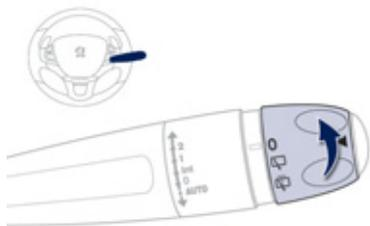
**!** En cas de neige ou de givre important et lors de l'utilisation d'un porte-vélos sur le coffre, neutralisez l'essuie-vitre arrière automatique en passant par le menu de configuration du véhicule.
