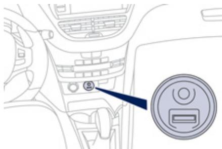
Ce boîtier de connexion, composé d'une prise JACK et USB, est situé sur la console centrale. Il vous permet de brancher un équipement nomade, tel qu'un baladeur numérique de type iPod® ou une clé USB.
