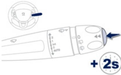
☞ Lorsque le parcours désiré est affiché, appuyez plus de deux secondes sur le bouton, situé à l'extrémité de la commande d'essuie-vitre.
